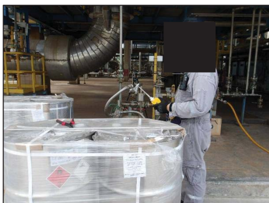
รูปที่ 3.6 การสูบน้ำสารเอทิลีนไดคลอไรด์
